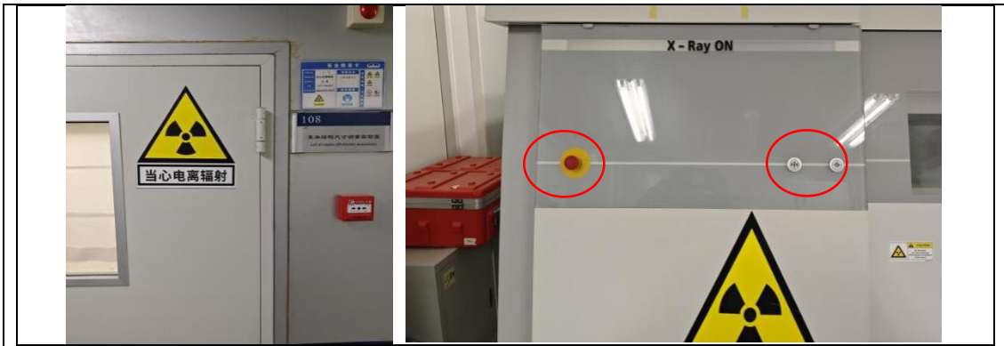
(2) 电离辐射警告标志、三色灯、开关门按钮等
